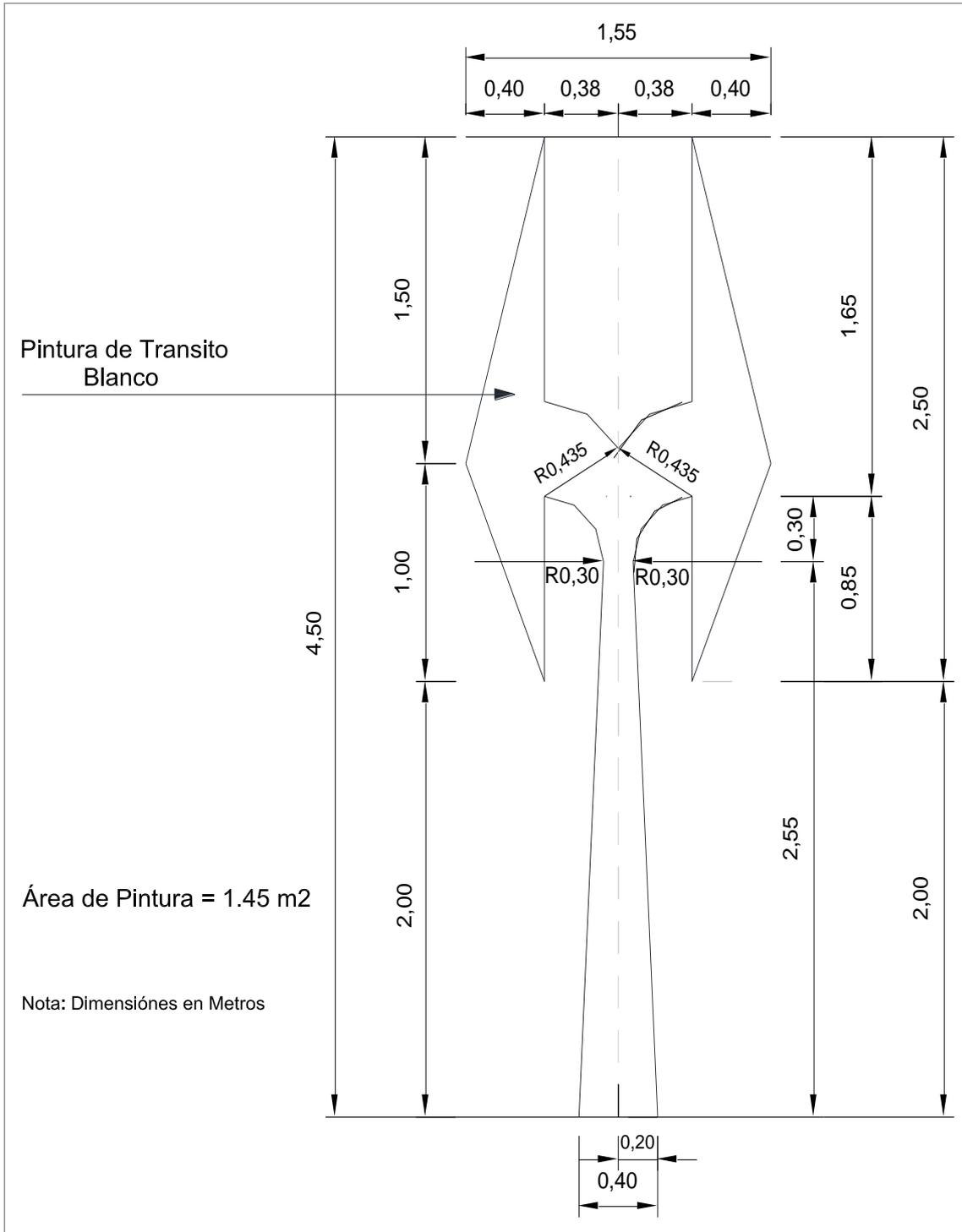
**Figura 3.40 Dimensiones de combinación de flecha recta y de giro (70 km/h o mayor)**
