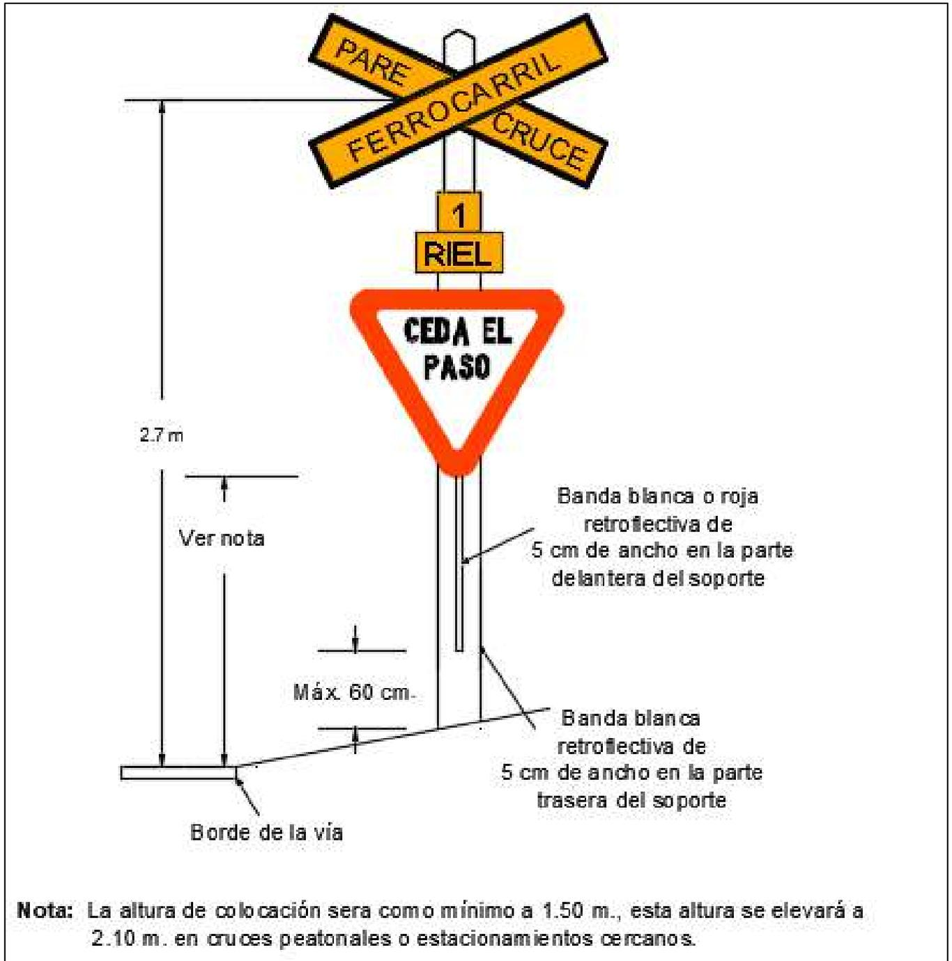
(Continua) **Figura 4.30 Ejemplos de la señalización vertical y dimensiones para cruces ferroviario a nivel**
