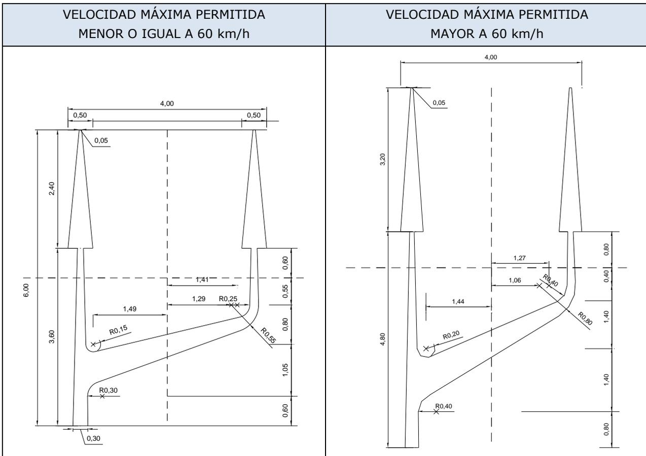
**Figura 3.45 Ejemplo de aplicación de incorporación a carriles exclusivos**
