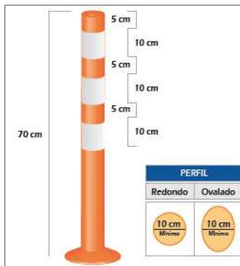
En la **Figura 5.5** se muestra ejemplos de delineadores compuestos.
