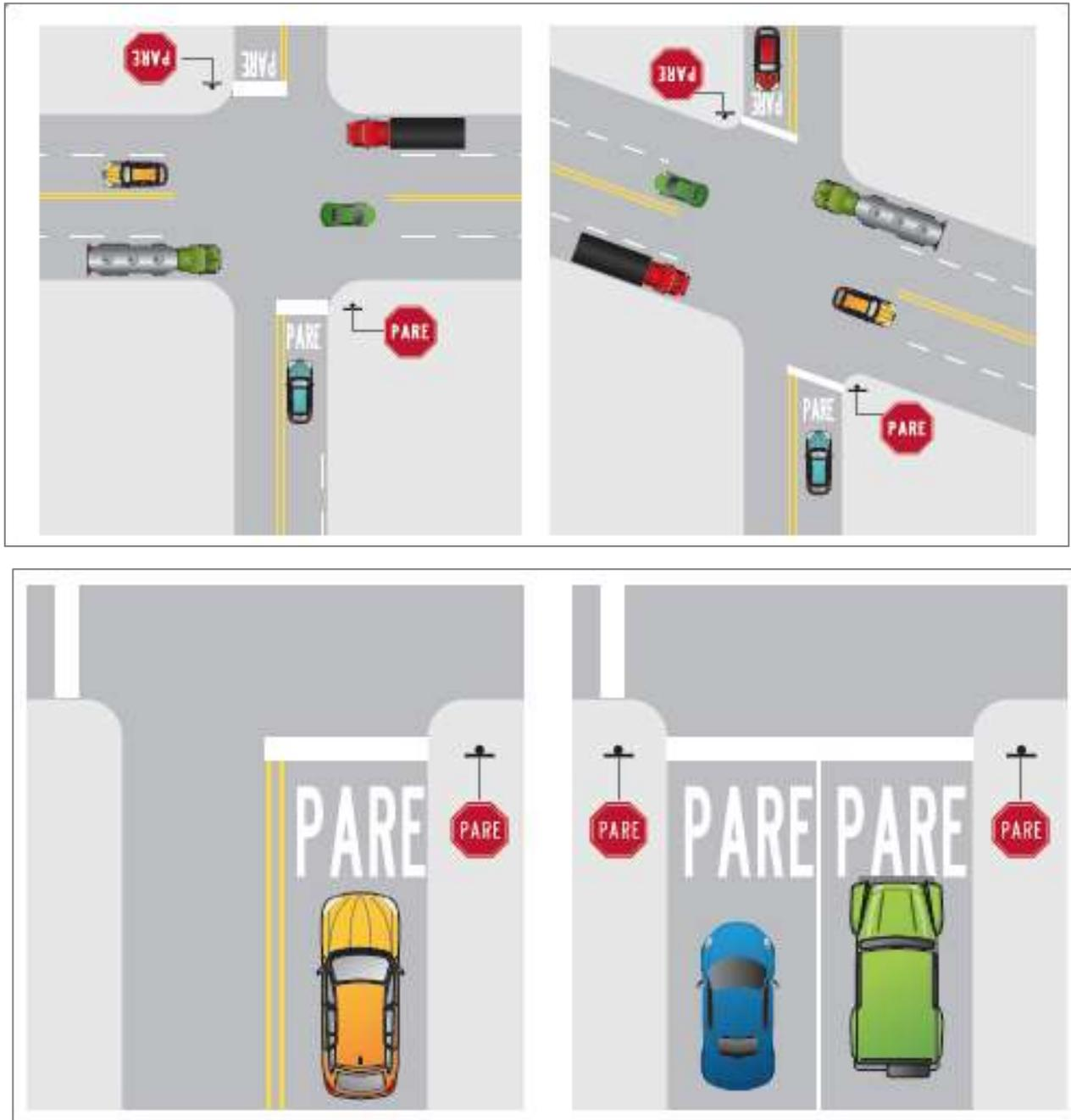
**(Continua) Figura 3.14 Ejemplos de demarcación de línea de pare con dimensiones**
