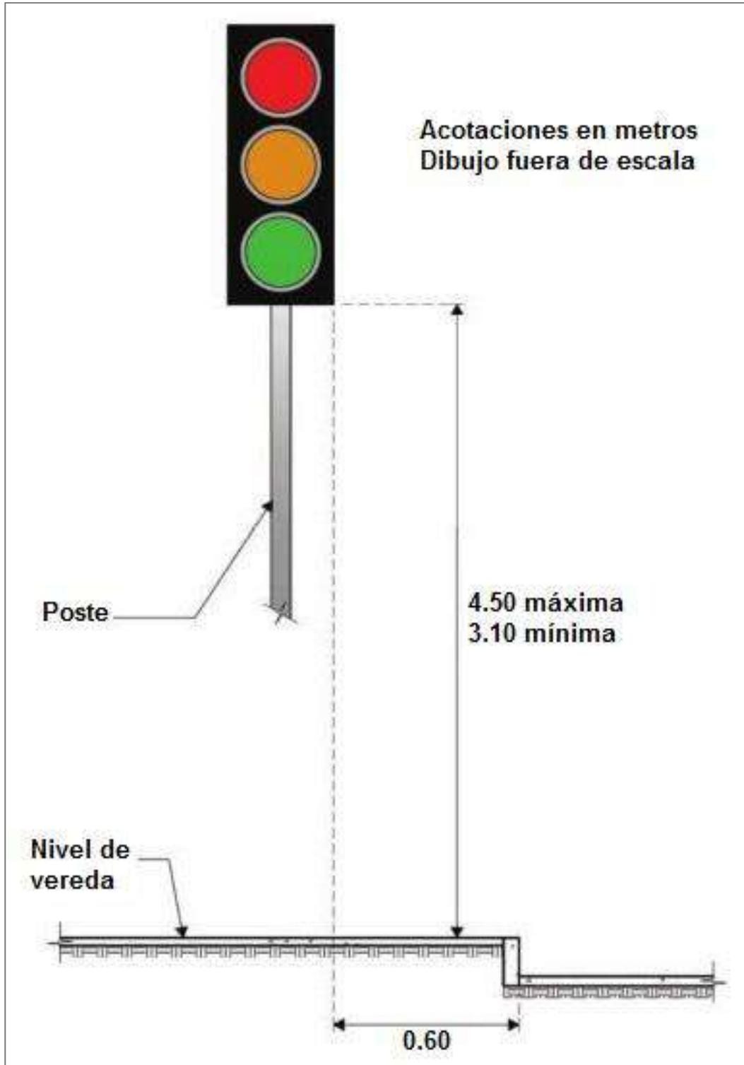
**Figura 6.2 Ejemplo de soporte de semáforo tipo ménsula**
