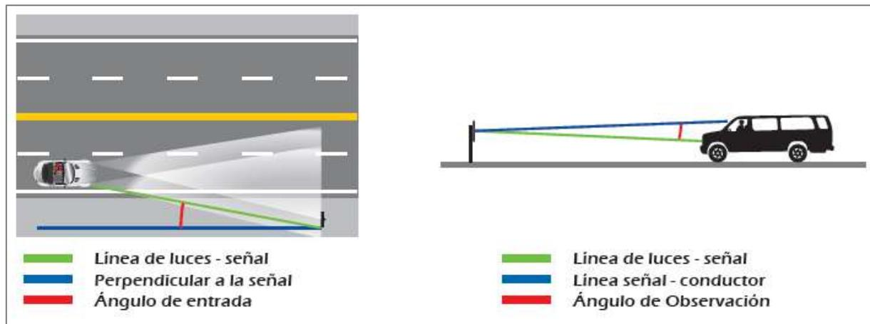
Para señales ubicadas a la izquierda debe aumentarse el valor de la retrorreflexión por un factor de 1,5 y para las señales aéreas por un factor de 3, ya que éstas normalmente no son iluminadas totalmente por los faros del vehículo.
