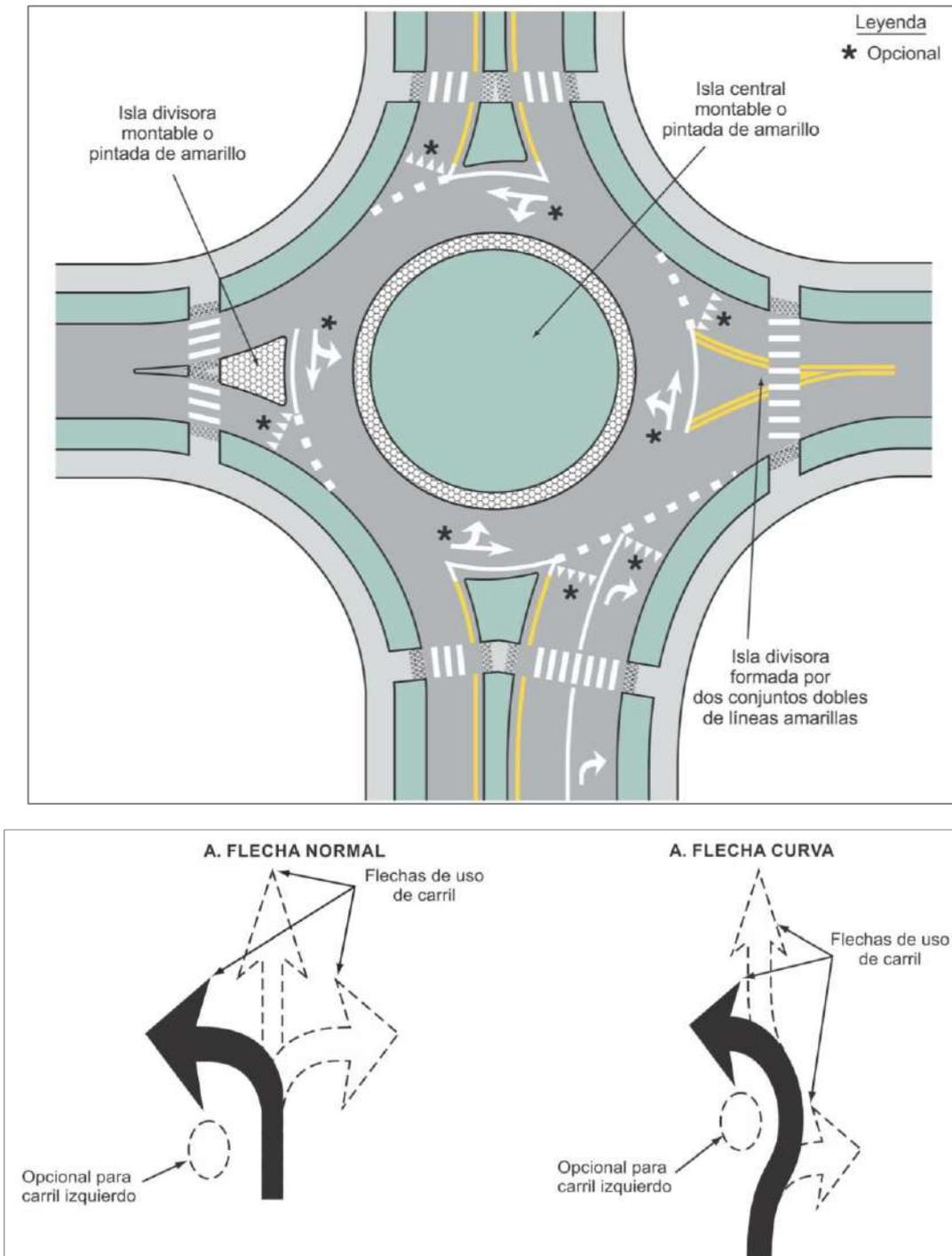
**Figura 3.22 Ejemplo de demarcación para intersecciones tipo Rotonda o Glorieta de dos carriles con uno o dos carriles de circulación**
