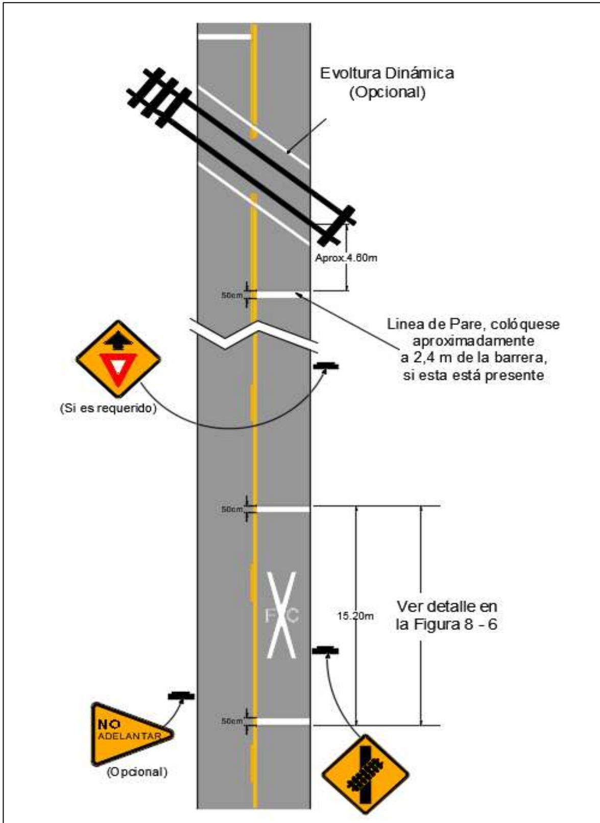
En la **Figura 4.32**, se muestra ejemplos de demarcación en el pavimento y dimensiones de un cruce ferroviario a nivel.
