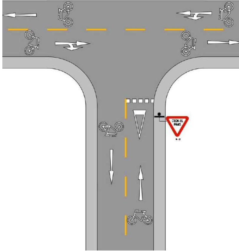
En la **Figura 4.10**, se muestra un ejemplo de dimensiones de demarcación en el pavimento "CEDA EL PASO" en intersección de "CICLOVÍA" con una vía de tránsito de vehículos motorizados.
