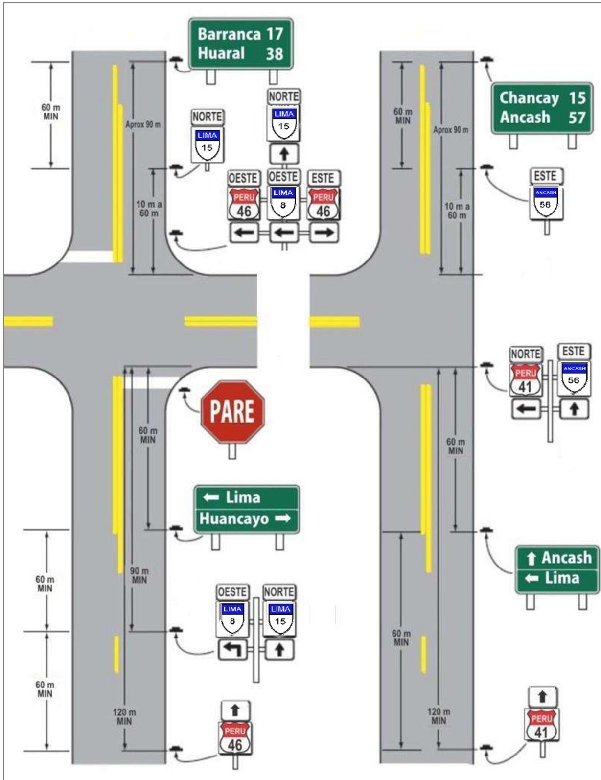
**Figura 2.30 Ejemplo de conjunto de indicadores de ruta**
