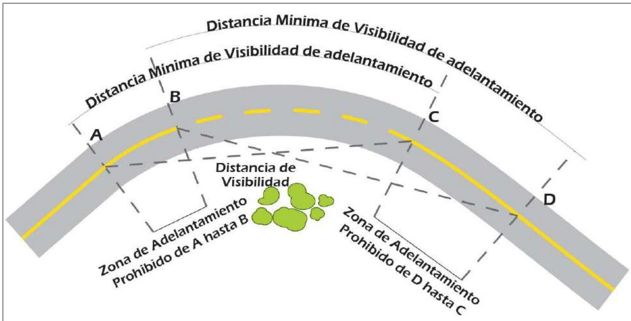
En la **Figura 3.10** se muestra un ejemplo de zona o tramo con prohibición de adelantamiento complementado con señalización vertical.
