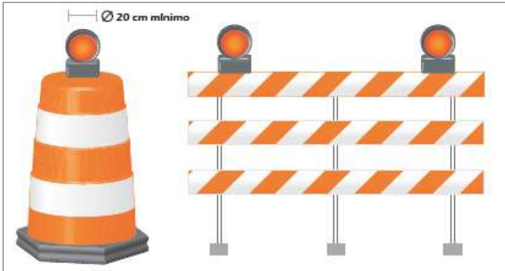
En la **Figura 5.10** se muestra un ejemplo de hitos de vértice con dimensiones.
