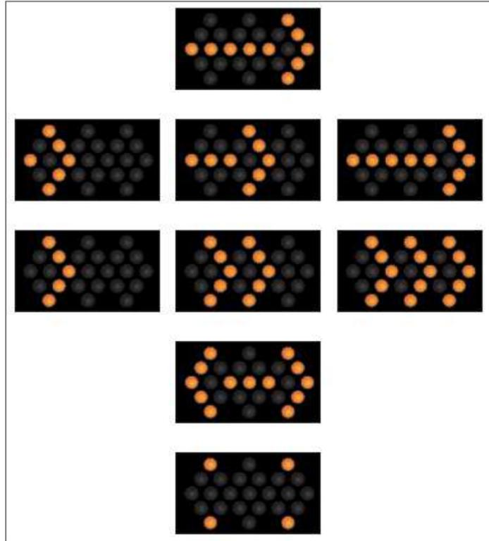
En la [Figura 5.12](#) se muestra un ejemplo de señal informativa de panel luminoso para mensajes variables.
