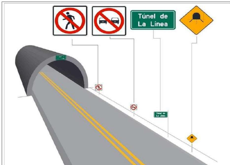
En la **Figura 4.37**, se muestra un ejemplo de señalización vertical y horizontal en la zona previa de acceso a un doble túnel o gemelos.
