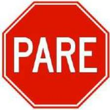
Esta señal dispone que el Conductor debe detener completamente el vehículo. Se colocará al borde de la vía como mínimo a una distancia de 2 m del inicio de la vía interceptada. Generalmente se complementa con marcas en el pavimento correspondiente a la línea de parada o cruce de peatones.
