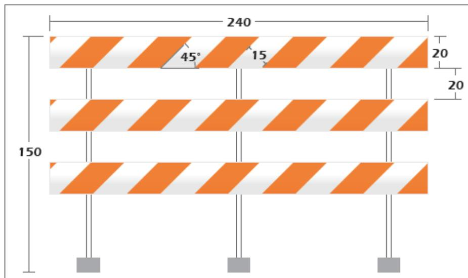
En la **Figura 5.7** se muestra un ejemplo y dimensiones de una barrera o tranquera tipo maletín o con características de un sistema de contención con dimensiones.
