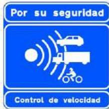
Señal de Poste la lámina tipo IV y para Señales Elevadas la del tipo XI. (EG- vigente)
