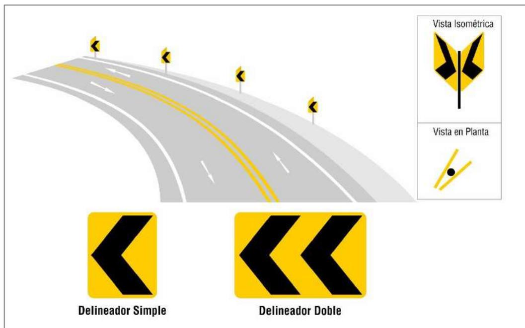
En la [Figura 3.55](#), se muestra las dimensiones de los delineadores simples y dobles, en función a la velocidad máxima permitida en la vía.
