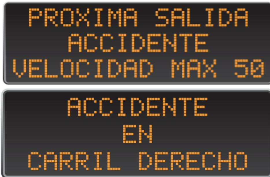
En la [Figura 2.52 y 2.53](#) se muestra un ejemplo de una señal de mensaje variable luminoso de carácter informativo de una línea complementada con una señal reglamentaria de límite de velocidad.
