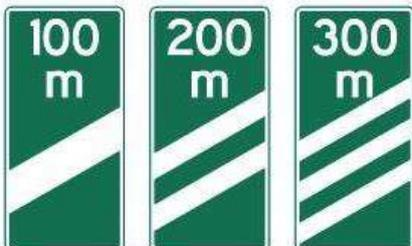
Se utilizan sólo en autopistas para indicar la distancia de 300 m, 200 m y 100 m al inicio del carril deceleración o de salida. Sólo se deben usar en conjunto con señales de pre señalización y de dirección.
