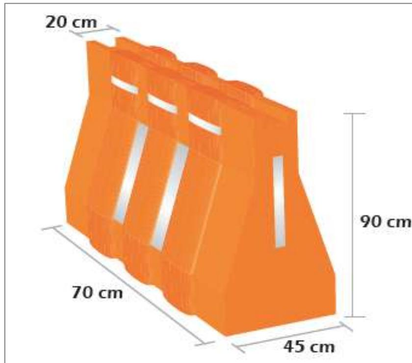
En la [Figura 5.8](#) se muestra un ejemplo de una barrera tipo tambor con dimensiones.
