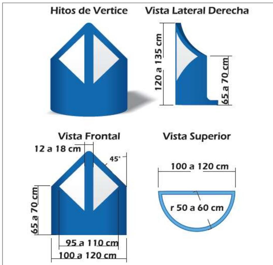
En la **Figura 3.62**, se muestra un ejemplo de demarcación de delineador tipo "Hito Luminoso" que se utiliza para destacar la presencia de una isla peatonal o reforzar una restricción de ancho de la vía.
