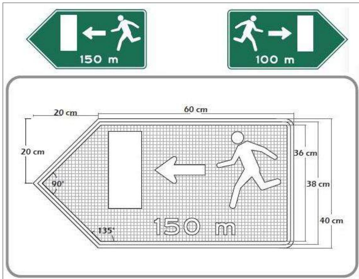
En la **Figura 4.40**, se muestran ejemplos de señales de estaciones de seguridad y auxilio (SOS).
