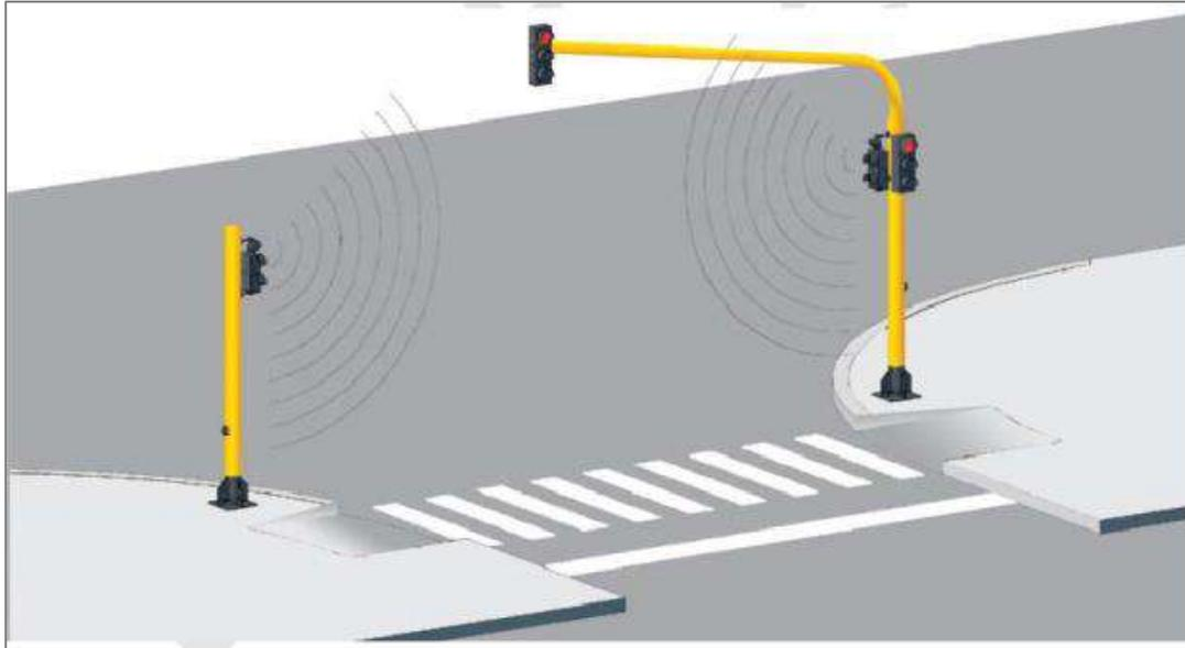
En la **Figura 6.23** se muestra un ejemplo de un semáforo peatonal donde se indica la localización de las ondas sonoras y el dispositivo manual de activación.
