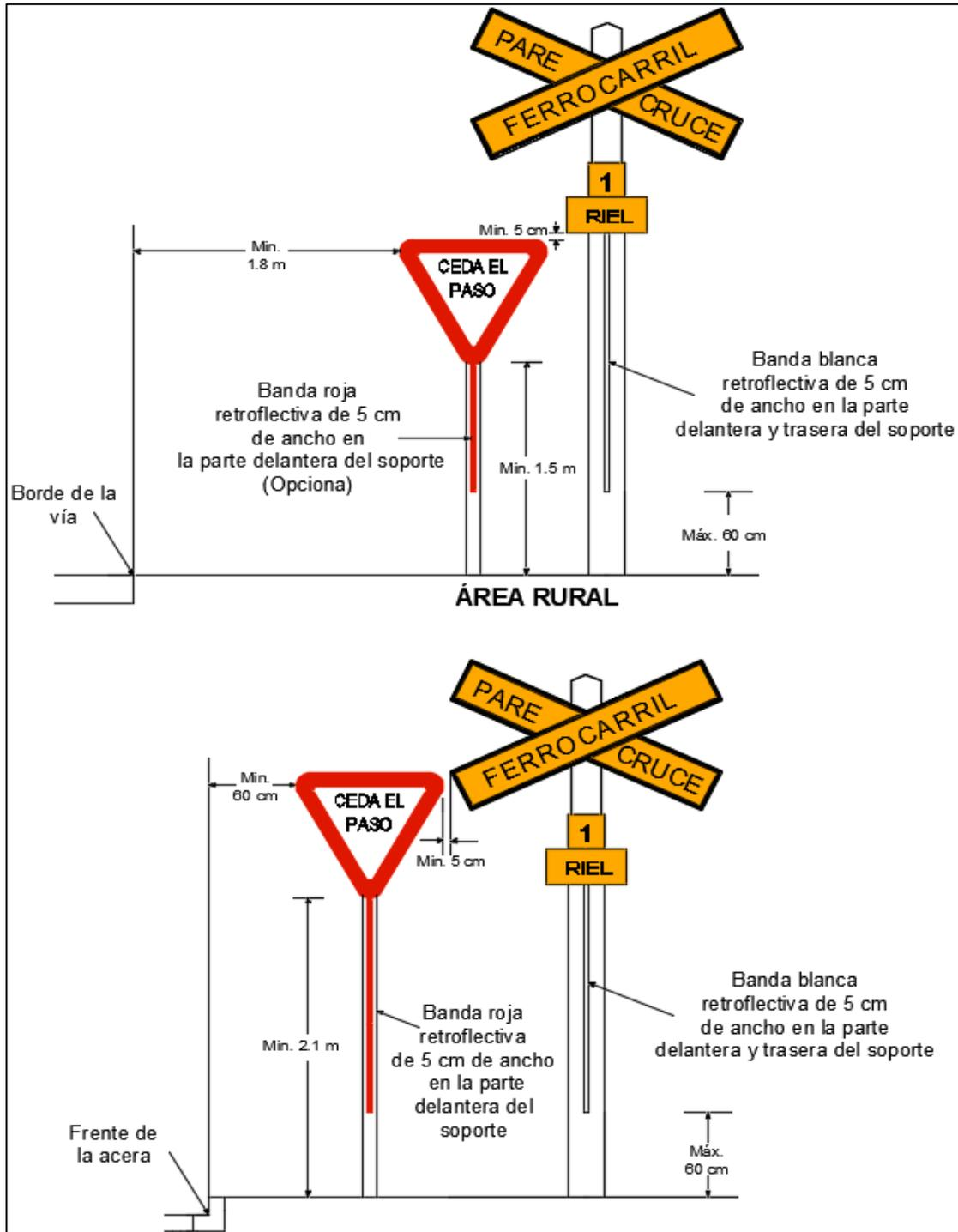
Donde exista una distancia de visibilidad restringida o geometría desfavorable en proximidad a un cruce a nivel, o donde exista un cruce en una vía de un solo sentido con múltiples carriles, se debe instalar señalización adicional en el lado izquierdo de la vía.
