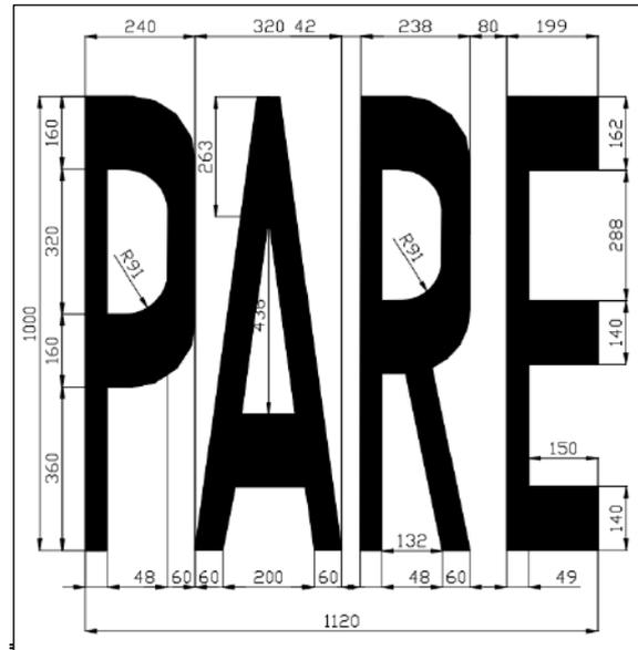
**Figura 4.6 Ejemplo de dimensiones de demarcación en el pavimento "PARE" en intersección de "CICLOVÍA" con una vía de tránsito de vehículos motorizados.**
