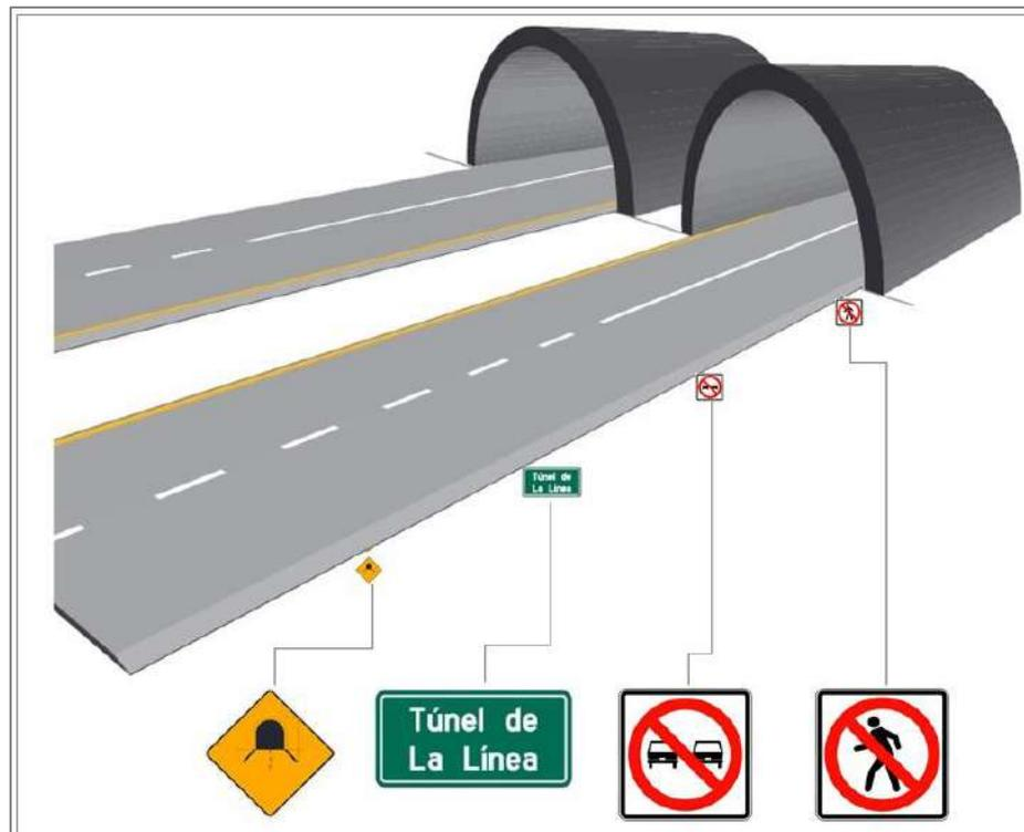
A continuación, se presentan ejemplos de dispositivos de control para las zonas de transición e interior del túnel, en el cual adicionalmente debe colocarse elementos captafaros en los muros del túnel, espaciados de 8 m. a 12 m., y a una elevación uniforme entre 0.50 m. y 0.90 m. sobre la superficie de rodadura.
