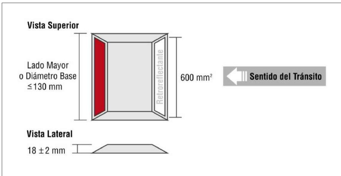
Las tachas retrorreflectivas se deben instalar al lado derecho a 0.05 m. de las demarcaciones planas continuas y en el caso de demarcaciones planas segmentadas se colocará al centro de la brecha o el tramo discontinuo. En caso de no existir berma pavimentada se instalará pegada al lado izquierdo de la línea de calzada.
