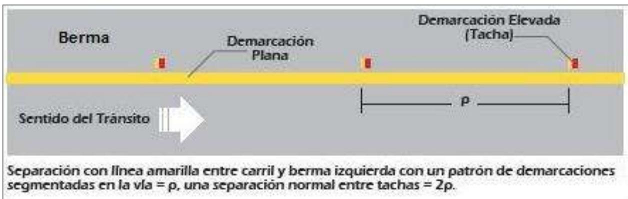
(Continua) Figura 3.3 Ejemplos de línea de borde de calzada o superficie de rodadura
