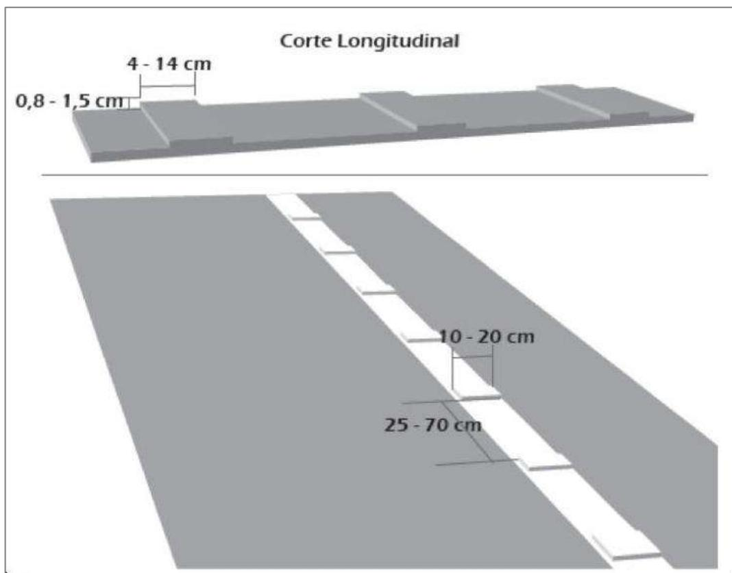
**Figura 3.50 Ejemplo de demarcación bajo relieve**
